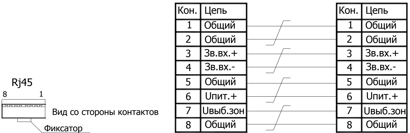
Рисунок 2 Схема соединения кабеля Нумерация контактов разъема Rj-45 условная.
